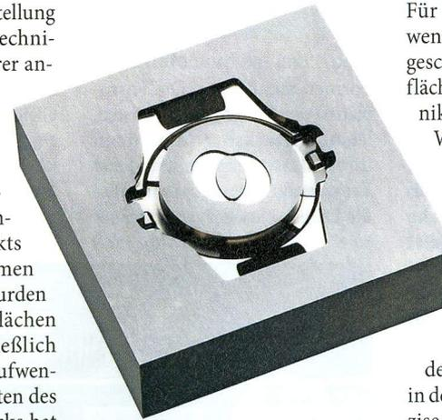
**Erodiertpolierte Kavität für das Spritzen von Uhrengehäusen**
