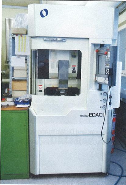
**Senkerodieren vom Feinsten:** Mittlerweile gehören zwei Senkerodiermaschinen des Typs EDAC I zum Maschinenpark von Leonhardt. (Bild: Schröder)
