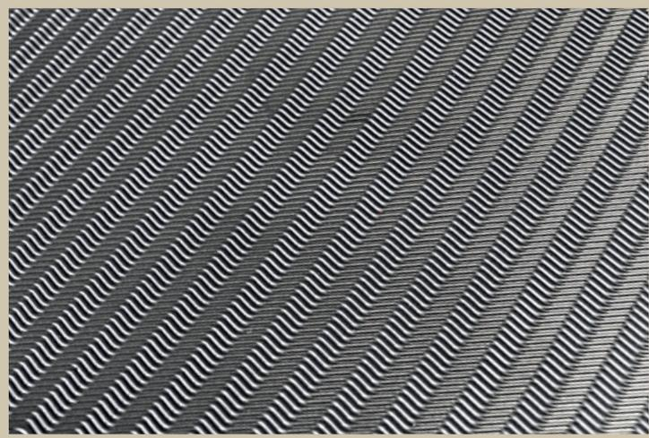
**Bild 6. Teilansicht einer filigran strukturierten Bipolarplatte für eine Brennstoffzelle: Es gilt, eine Planparallelität der Bleche von wenigen Mikrometern zu erreichen**
